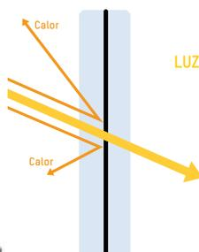
Laminados transparentes para un alta aportación de luz y un control eficiente del calor excesivo. Permiten un alta luminosidad y bloquean el calor sin reflexión. Se fabrican en medidas máximas de 2440 x 5000 mm.
